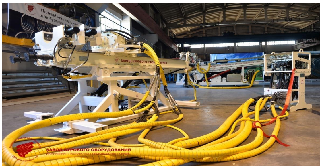
Рис. 2. Подземная буровая установка ZBO U15A
